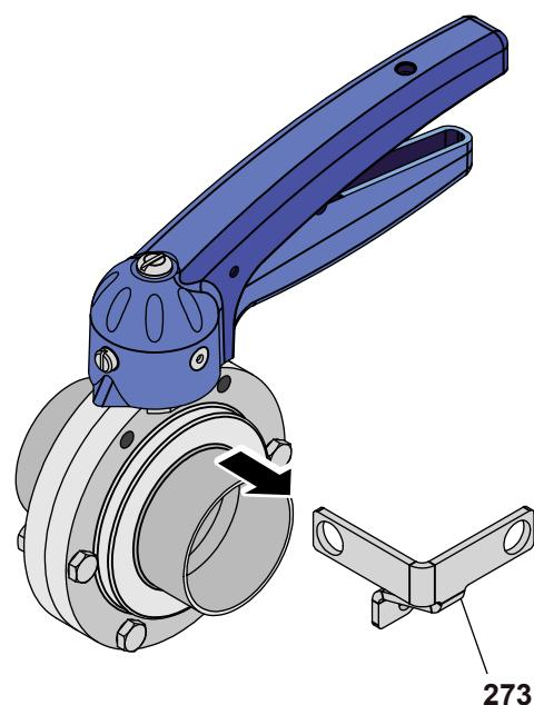
**10.13 MONTAGE DE LA VVF avec deux capteurs cylindriques**
