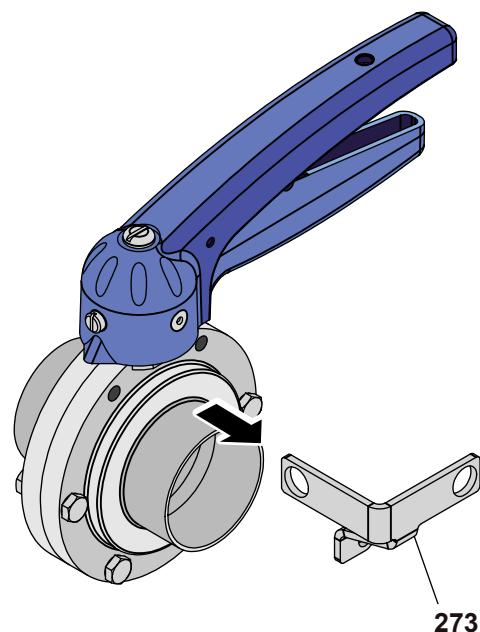
**10.13 montaje de la VVF con dos sensores cilíndricos**
