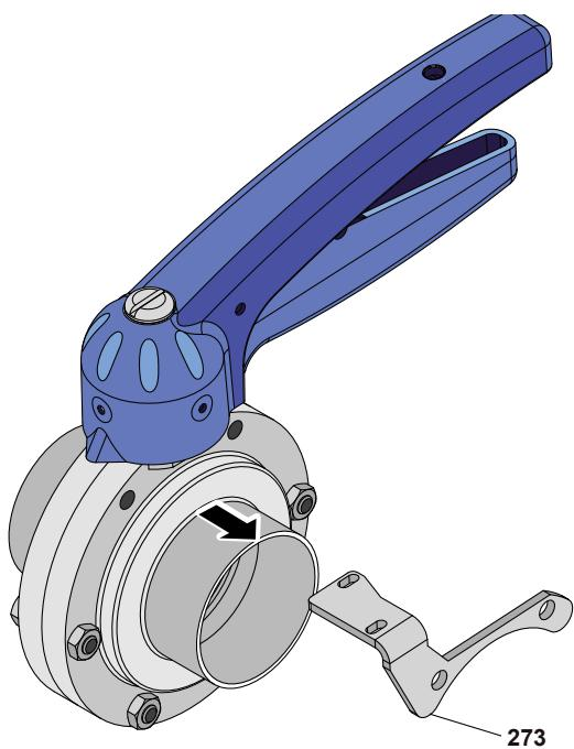
**10.11 montaje de la VVF con dos sensores**
