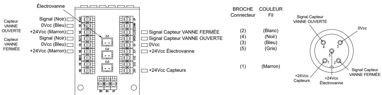
**1,2 capteurs PNP avec 2 électrovannes (1 N.F. et 1 N.O.) pour double effet et connecteur 5 pôles**
