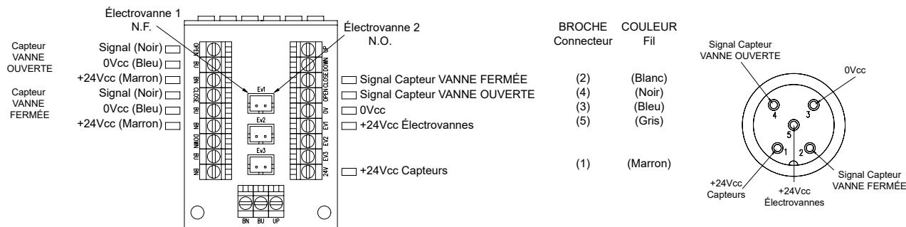
**1,2 capteurs PNP avec 1,2 électrovannes normalement fermées**
