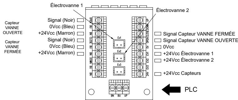
**1,2 capteurs PNP avec 2 électrovannes (1 N.F. et 1 N.O.) pour double effet**
