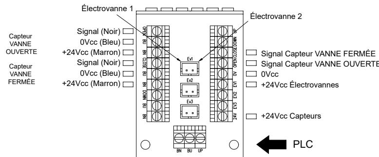
**1,2 électrovannes normalement fermées et connecteur 5 pôles**
