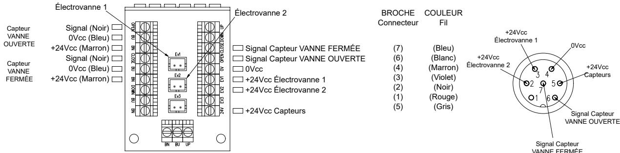
**1,2 capteurs PNP avec 2 électrovannes (1 N.F. et 1 N.O.) pour double effet et connecteur 7 pôles**
