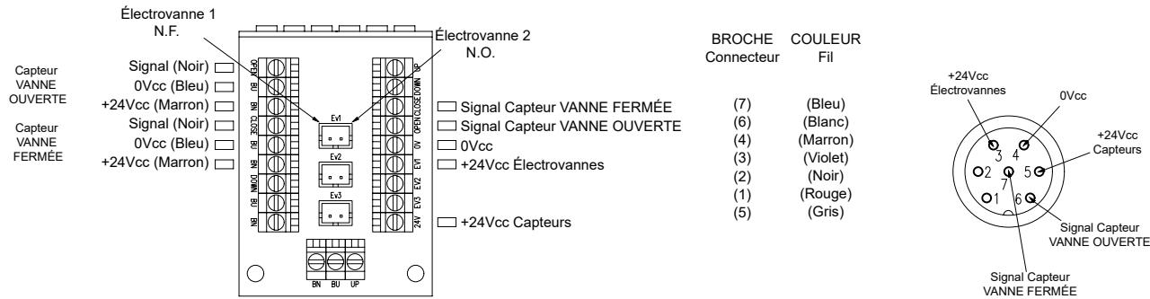
**1,2 capteurs PNP avec 1 électrovanne normalement fermée et connecteur 5 pôles**
