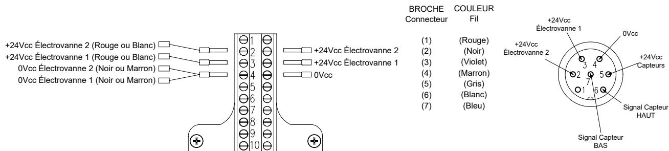
**1,2 électrovannes normalement fermées et connecteur 5 pôles**
