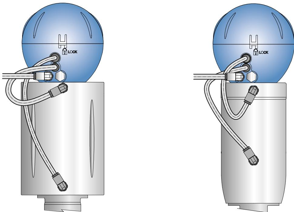
**Vanne avec actionneur à simple effet avec « Twin Stop »**
