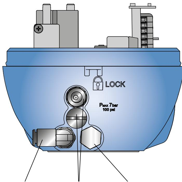
Entrée air comprimé. Utiliser un tube de diamètre extérieur 6 mm
