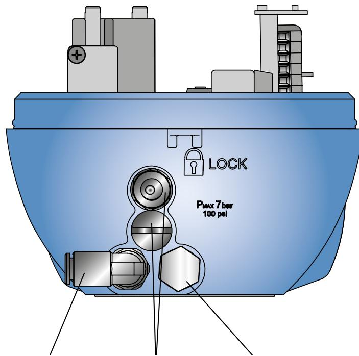
Entrada de aire comprimido. Utilizar un tubo con un diámetro exterior de 6 mm. Bajo pedido es posible suministrar un racor para tubo de 1/4"
