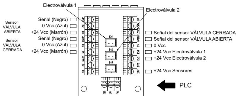
**1, 2 sensores PNP con 2 electroválvulas (1 N.C. y 1 N.A.) para doble efecto**
