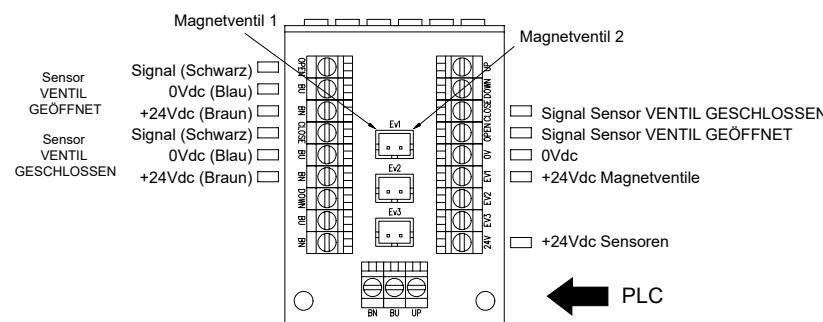
**1,2 normalerweise geschlossene Magnetventile und 7-poliger Steckverbinder**
