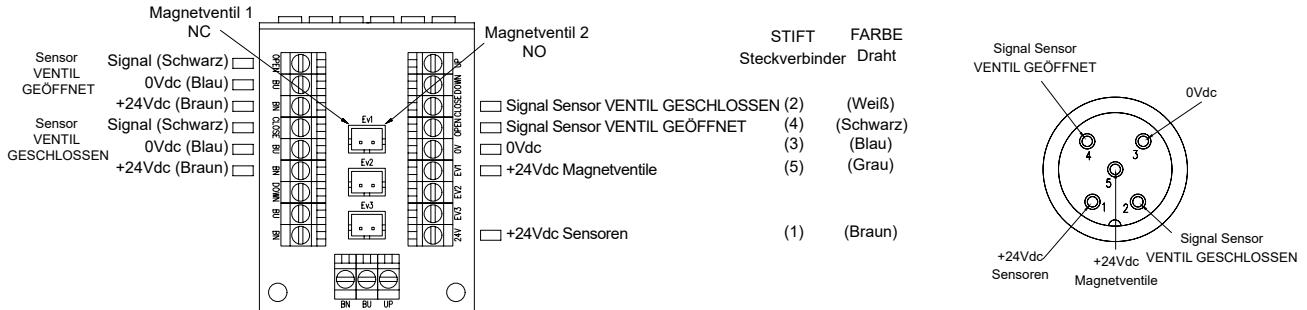
**1,2 PNP-Sensoren mit 1,2 normalerweise geschlossenen Magnetventilen**
