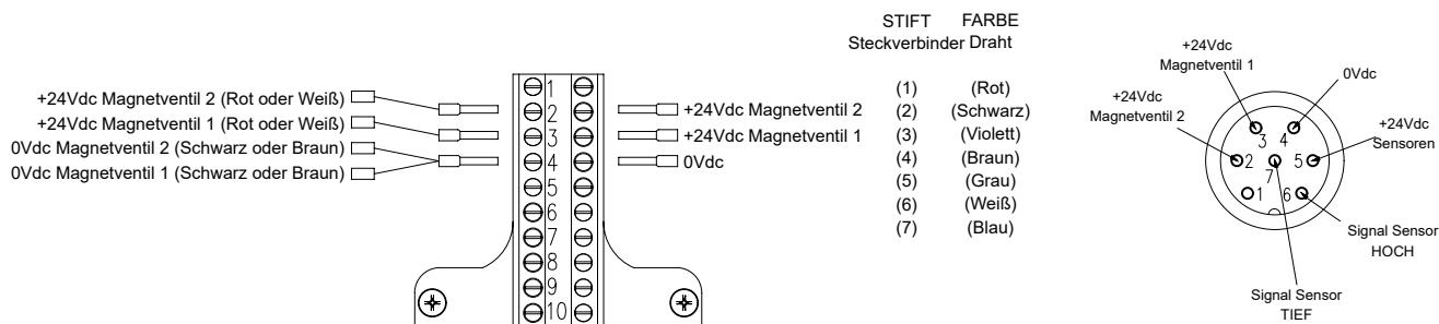
**1,2 normalerweise geschlossene Magnetventile und 5-poliger Steckverbinder**
