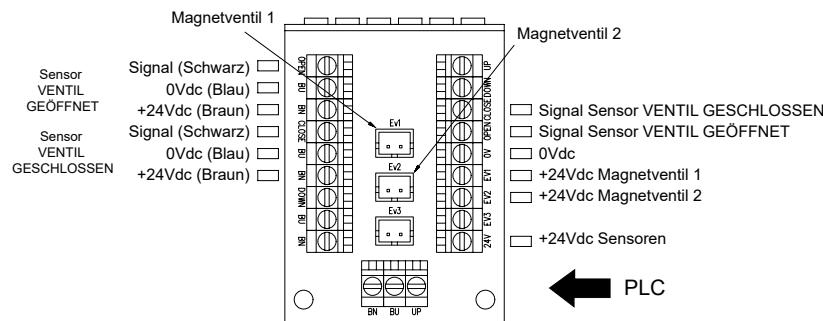
**1,2 PNP-Sensoren mit 2 Magnetventilen (1 NC und 1 NO) für Doppeltwirkung**
