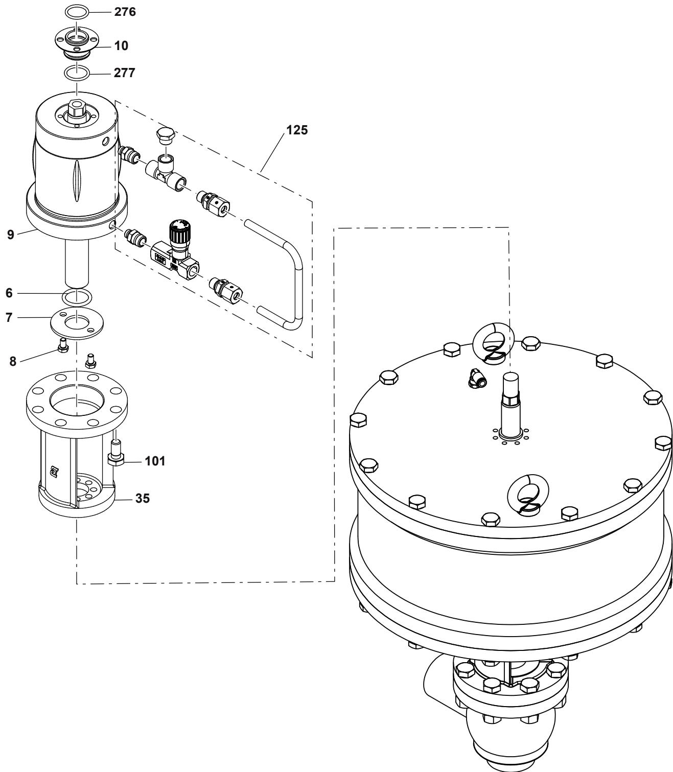
**10.17 Desmontaje de Cilindro 207-360 con amortiguador**
