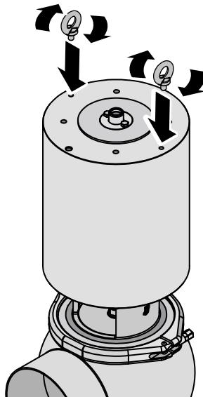
Une fois la vanne installée il est nécessaire de retirer les œillets et de réinstaller les vis.
