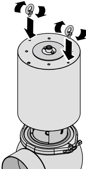
Una vez instalada la válvula, desmontar los cáncamos y volver a colocar los tornillos..
