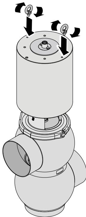
Nach Installation des Ventils sind die Hubösen abzunehmen und die Schrauben einzusetzen.
