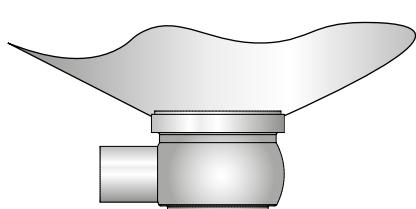
Souder avec grande attention, essayer de réaliser une soudure sans stresser le matériau, afin d'éviter toute déformation sur les zones d'étanchéité. Contrôler le fonctionnement de la vanne après la soudure.
