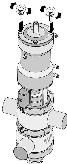
Une fois la vanne installée il est nécessaire de retirer les œillets et de réinstaller les vis.
