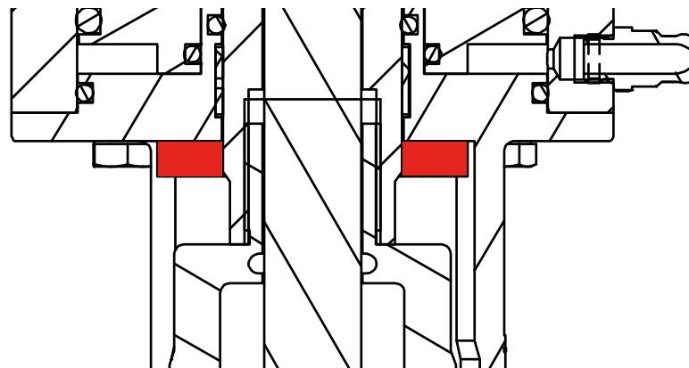
Effectuer la levée supérieure de la vanne et vérifier que le capteur commute l'état en présence de la came, en cas contraire, il est nécessaire de régler le capteur.
