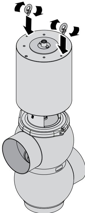
После монтажа клапана извлечь рым-болты и вставить винты.
